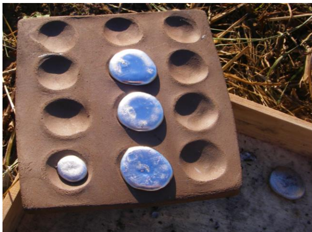
Figure 7 : moule en argile avec un flan globulaire de 8 g. (trop court) et les flans plus larges de plus de 16 g.
