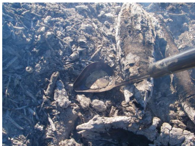
Figure 6 : fusion de l'étain dans une louche en inox sur un feu de bois.
